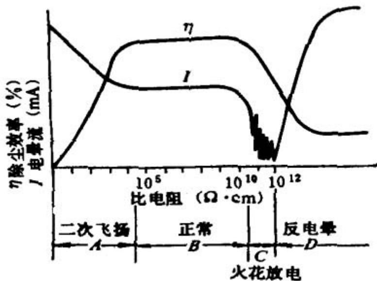
图 1 粉尘比电阻与除尘效率之间的关系
